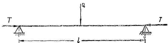
Рис. 28. Изгиб стержня, сжатого продольными силами.
